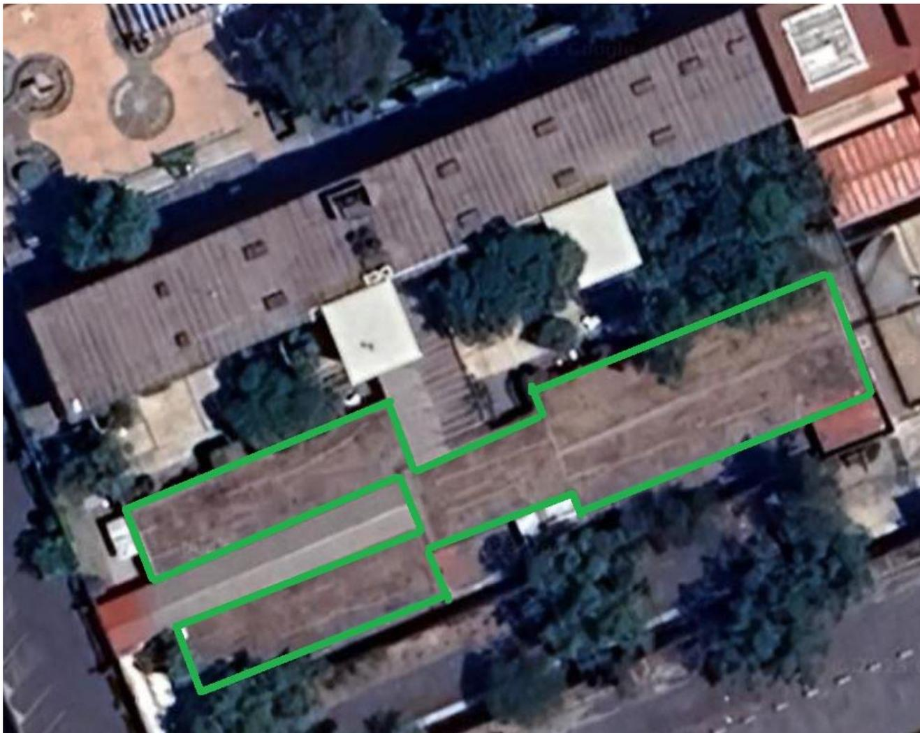
Se requiere retirar el impermeabilizante anterior y aplicar un nuevo recubrimiento prefabricado de impermeabilizante y reparar las bajadas de agua con tubería de PVC rígido de al menos 4".
