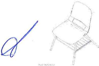
DESCRIPCIÓN: SILLAS ALUMNO SIN PALETA. BASE 4 PATAS. ESTRUCTURA TUBULAR DE ACERO. 17.5" DE ALTURA APROXIMADAMENTE. ESTRUCTURA EN CALIBRE 16. ASIENTO Y RESPALDO EN POLIPROPILENO DE UNA SOLA PIEZA. ESTRUCTURA EN ACERO TUBULAR REDONDO. CON CANASTILLA.
