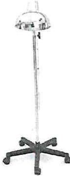
DESCRIPCIÓN: LÁMPARA (PARA CONSULTORIO MÉDICO). LÁMPARA DE CHICOTE. CON HAZ DIRECCIONABLE, BASE TRIPEÉ FABRICADA DE TUBO CUADRADO DE 1 1/2 PULGADA CALIBRE 18 ACABADO CROMADO. ANTENA TELESCÓPICA EN TUBO FLEXIBLE DE 1/2 PULGADA DE DIÁMETRO CALIBRE 18 ACABADO CROMADO. PANTALLA GRANDE DE ALUMINIO ANODIZADO COLOR NATURAL DE 26.2 CM DE DIÁMETRO. SISTEMA OPRESOR POR MEDIO DE PERILLA DE PLÁSTICO. RUEDAS TIPO YOYO DE 2 PULGADAS DE DIÁMETRO COLOR NEGRO. ALIMENTACIÓN ELÉCTRICA 127 W60HZ.
