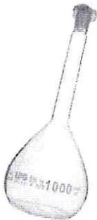
DESCRIPCIÓN: MATRAZ AFORADO DE VIDRIO DE 1000 ML. CON LÍNEA DE AFORO EN EL CUELLO Y CON TAPÓN DE VIDRIO ESMERILADO.
