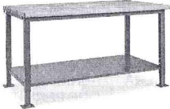
DESCRIPCIÓN: MESA DE TRABAJO DE USO PESADO, LARGO Y ANCHO DE 60 X 36", ALTURA AJUSTABLE DE 29 A 39" EN INCREMENTOS DE 2", PERÍMETRO COMPLETO DEL ARMAZÓN DE ACERO, PLACAS PERFORADOS PARA FIJAR AL PISO, REPISA INFERIOR DE ANCHO COMPLETO, CUBIERTA EN MADERA COMPRIMIDA CON BORDES REDONDEADOS; DIMENSIONES REPISA INFERIOR: TOTALES: 57 7/8 X 28" (ANCHO X PROFUNDIDAD), ESPACIO LIBRE DE ALTO: 22", ESPACIO LIBRE
