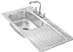
DESCRIPCIÓN: TARJA DE ACERO INOXIDABLE EMPOTRABLE, CON UNA TINA Y ESCURRIDOR, DE 80 CM DE LARGO, 51 CM DE ANCHO Y 15.8 CM DE PROFUNDIDAD, CON UN DIÁMETRO DE DESAGÜE DE 3 1/2 PULGADAS Y CON TRES AGUJEROS PARA MEZCLADORA ESTÁNDAR. CON UNA LLAVE MEZCLADORA CON CHAPETÓN DE CUELLO DE GANSO, FABRICADA EN LATÓN CON CONEXIONES DE 1-1/2", CON MANERALES TIPO PALANCA, AIRADOR Y UNA CONTRA DE CANASTA DE 4" . CONTARÁ CON
