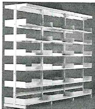
DESCRIPCIÓN: 2.10 MTS DE ALTO, FABRICADO CON LÁMINA COLD ROLLED DE CALIBRE 14, TERMINADOS CON PINTURA EN POLVO EPÓXICA MICRO PULVERIZADA APLICADA ELECTROSTÁTICAMENTE Y HORNEADA A 200° C CON PREVIO TRATAMIENTO DE LAVADO Y DESENGRASADO FOSFATIZADO POR ASPERSIÓN. INCLUYE: 12 CHAROLAS, 2 CUBRE POLVOS Y NIVELADORES DE ALTURA DE POLIPROPILENO DE ALTO IMPACTO. MEDIDAS: 2.10 M DE ALTO X 60 CM DE FONDO X 90 CM.
