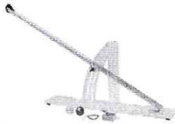
ÁNGULO DE 0 A 40° CON RESPECTO A LA HORIZONTAL. UNA ESCALA VERTICAL DE 0-25 CM SE ENCUENTRA TAMBIÉN IMPRESA PARA PODER MEDIR LA ALTURA DEL PLANO INCLINADO EN CUALQUIER PUNTO. EL EXTREMO DEL PLANO INCLINADO PRESENTA UNA POLEA REGULABLE DE LA CUAL PODER SUSPENDER MASAS, UN PLATILLO PARA PESAS, ETC. EL APARATO SE COMPLETA CON UN CARRITO DE PLÁSTICO CON GANCHO, UN JUEGO DE PESAS (IN-CLUYENDO 1×100 G, 1×50 G Y 1×20 G) Y UN PLATILLO CON UN CORDEL DE MASA DESPRECIABLE.
