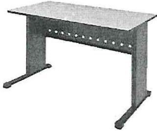
DESCRIPCIÓN: MESA PARA COMPUTADORA DE 1200 x 600 x 750 mm, ALTURA DE 750 MM, LONGITUD DE 600 MM Y PROFUNDIDAD DE 510 MM, ESTRUCTURA TUBULAR DE ACERO AL CARBONO, CUBIERTA DE POLIPROPILENO, ACABADO EN PINTURA EPÓXICA; GENERALIDADES: SE DEBERÁ FABRICAR EL MOBILIARIO CON EL MENOR NÚMERO DE PIEZAS QUE PERMITA EL MATERIAL, CON LA FINALIDAD DE MINIMIZAR EL USO DE UNIONES, LAS UNIONES ENTRE COMPONENTES DEBERÁN PERMITIR UN PERFECTO ENSAMBLE, TODAS LAS CARAS
