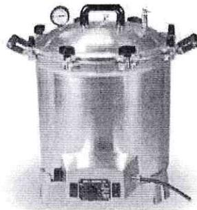
DESCRIPCIÓN: AUTOCLAVE ELÉCTRICA. CAPACIDAD APROXIMADA DE 14 LITROS, CERRADURA CON SUJETADOR TIPO TORNILLO DE SEGURIDAD, CUERPO DE ALUMINIO, LUZ PILOTO Y TERMOSTATO AJUSTABLE. RANGO DE OPERACIÓN APROXIMADA: TEMPERATURA 121 °C, PRESIÓN DE 1.4 PSI. REQUERIMIENTOS ELÉCTRICOS 110 VOLTS, 50-60 HZ.
