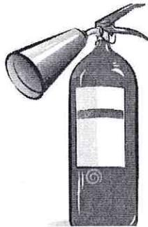
DESCRIPCIÓN: FABRICADA EN ACERO. CON MANGUERA Y TROMPA DIFUSORA. AGENTE: 10 LB, CO2. AGENTE EXPULSOR: CO2. PRESIÓN DE PRUEBA: 245 BAR. TEMPERATURA DE UTILIZACIÓN: -20° C +- 60° C. ENSAYO DIELECTRICO: 35 KV. EL CO2 NO ES CONDUCTOR EVITA LA TRANSMISIÓN DE CORRIENTE EN LUGARES DONDE ESTÁ PRESENTE LA ELECTRICIDAD, PARA SU USO EN SALAS DE CÓMPUTO, CENTROS DE DATOS.
