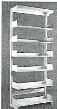
DESCRIPCIÓN: 2.10 MTS. FABRICADO CON LÁMINA COLD ROLLED DE CALIBRE 14, TERMINADOS EN PINTURA EN POLVO EPÓXICA MICRO PULVERIZADA APLICADA ELECTROSTÁTICAMENTE. INCLUYE: 6 CHAROLAS, 1 CUBRE POLVOS, NIVELADORES DE ALTURA DE POLIPROPILENO DE ALTO IMPACTO.
