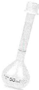
DESCRIPCIÓN: MATRAZ AFORADO DE VIDRIO DE 50 ML. CON LÍNEA DE AFORO EN EL CUELLO Y CON TAPÓN DE VIDRIO ESMERILADO.
